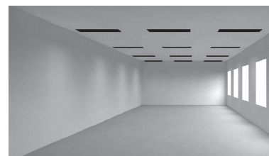
Fig. 44 a Visualisering av klasserom. Det er montert 12 armaturer på 2 x 36 W i rommet.
